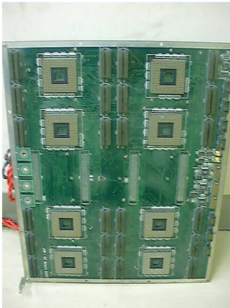
図 6.12 RDT backplane board の写真
