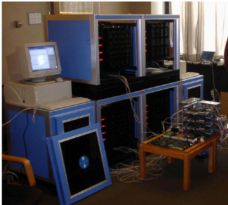
図 3.1 16 クラスタ 64 プロセッサの JUMP-1
