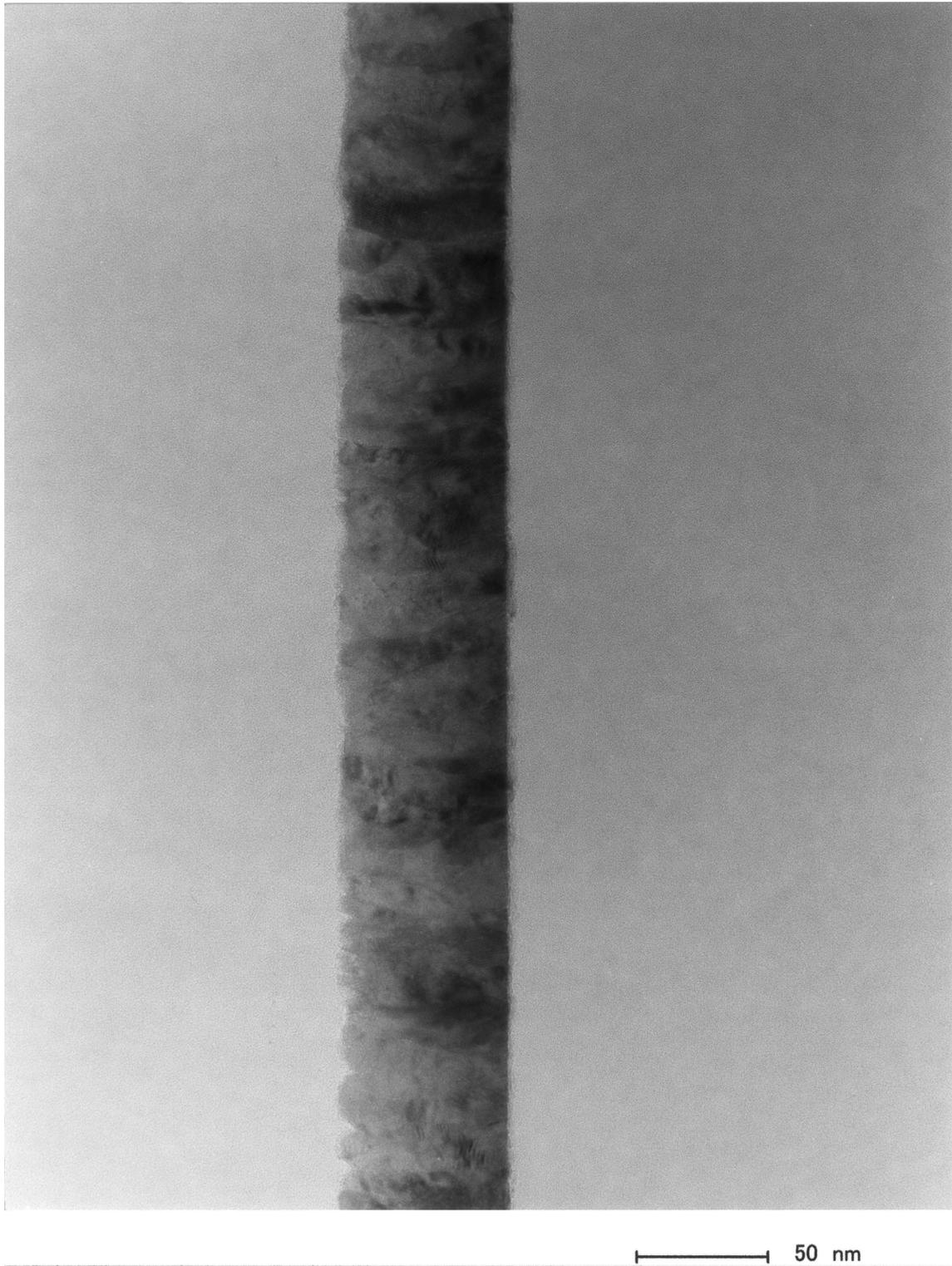
図 8-7 Mo 薄膜 70nm の TEM 断面写真. 500,000 倍. 右側がガラス基板. 中央の黒い帯がモリブデン薄膜である.
