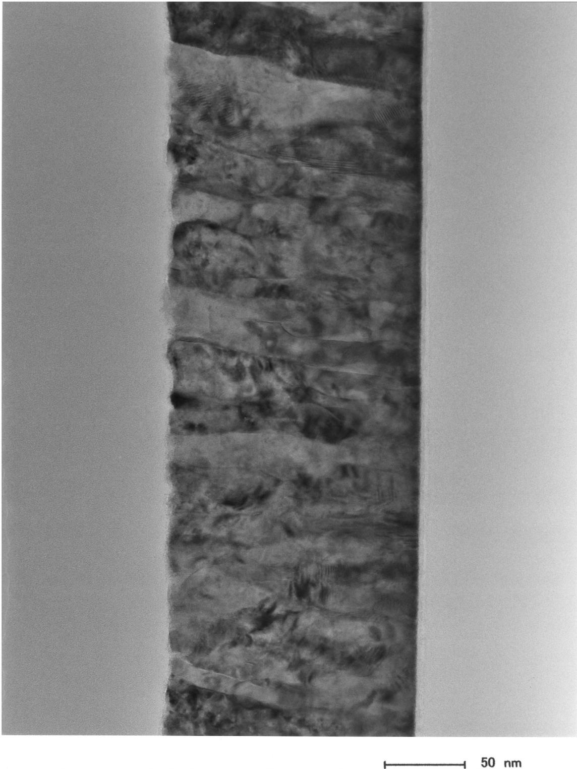
図 8-11 Mo 薄膜 200nm の TEM 断面写真. 500,000 倍. 右側がガラス基板. 中央の黒い帯がモリブデン薄膜である.
