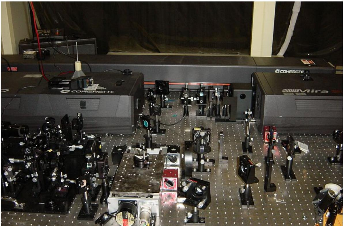
図 3-6 ピコ秒サーモリフレクタンス法薄膜熱拡散率計測システム.
