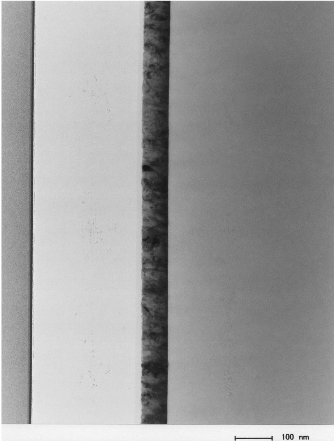
図 8-8 Mo 薄膜 100nm の TEM 断面写真. 200,000 倍. 右側がガラス基板. 中央の黒い帯がモリブデン薄膜である.
