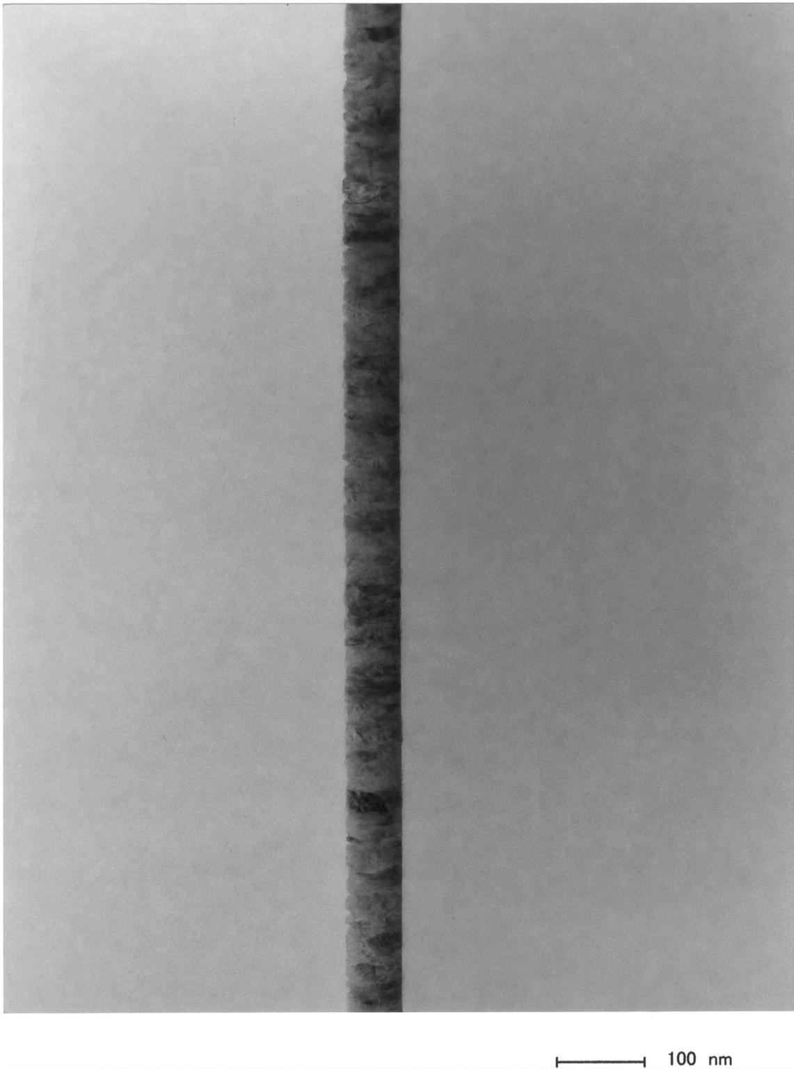
図 8-6 Mo 薄膜 70nm の TEM 断面写真. 200,000 倍. 右側がガラス基板. 中央の黒い帯がモリブデン薄膜である.
