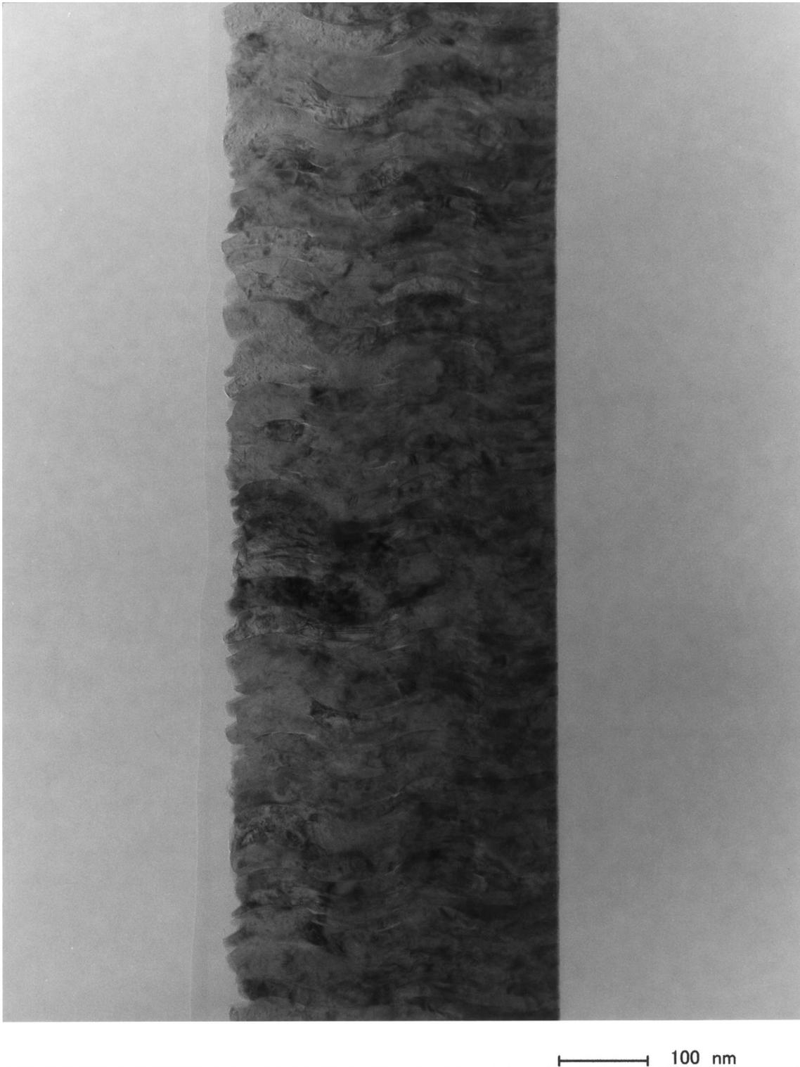
図 8-12 Mo 薄膜 400nm の TEM 断面写真. 200,000 倍. 右側がガラス基板. 中央の黒い帯がモリブデン薄膜である.
