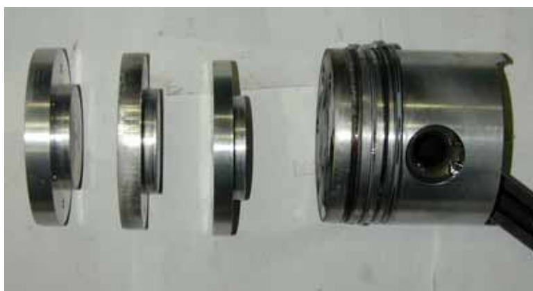
図 2-4 圧縮比を変更するために用意したピストンヘッドとピストン本体
