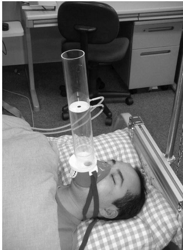
図 4.2 オリフィス流量計による換気量測定の様子
