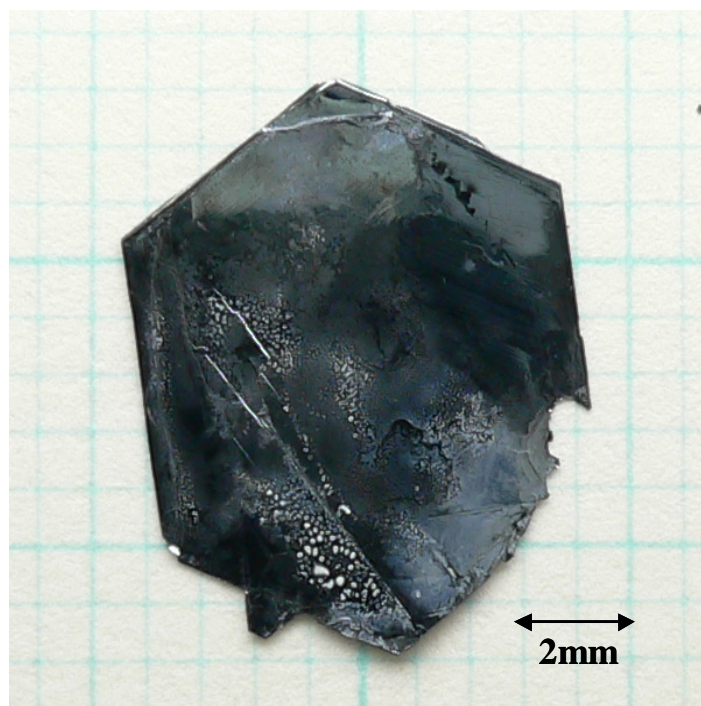
Fig.2.8 NaOH フラックス法にて合成した結晶の写真 .
