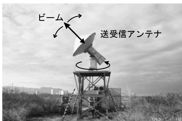
図 A-1 気象ドップラーレーダー（防衛大学）。冬季日本海メソ対流系観測－2002（Winter MCSs Observations over the Japan Sea-2002; WMO-02）三国サイトにて撮影。防衛大小林文明助教授のご協力による。
