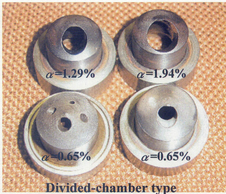
図 4.14 実験に用いた副室(連通孔面積比の影響)
