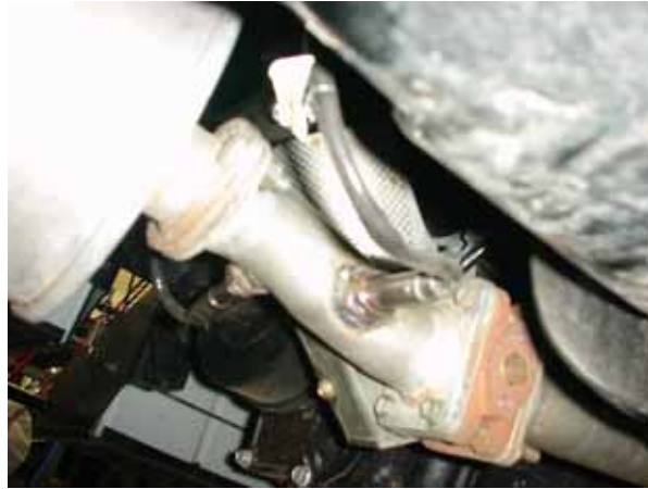
図 2.3 NOx センサおよび O 2 センサ取り付け状況
