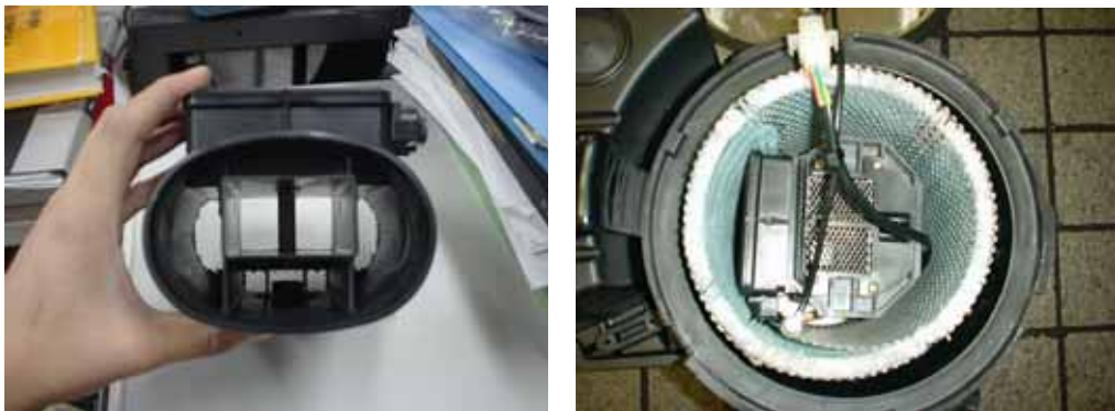
図 2.4 カルマン流量計およびエアクリーナ内取り付け状況
