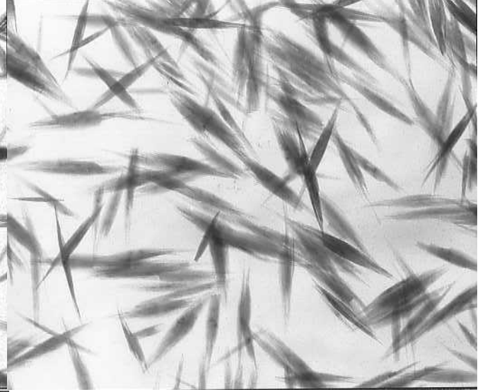
Fig.7-3 (a) 全体混合反応塔(循環無し) 酸化速度11.1%/h
