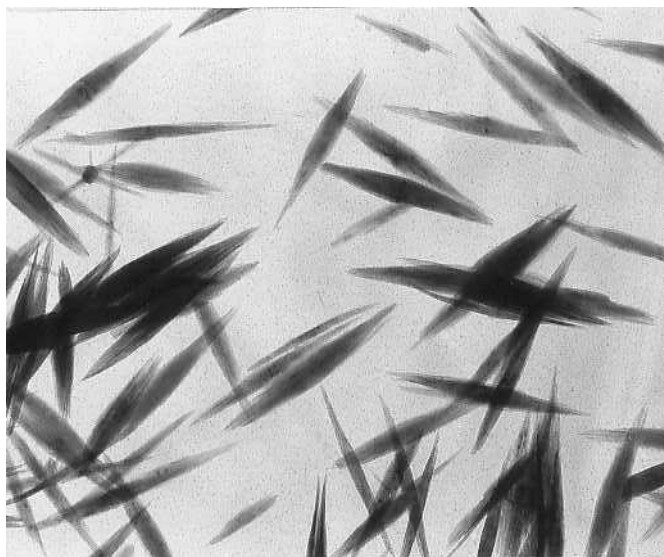
Fig.7-4 (a) 気泡分散攪拌機(循環有り) 酸化速度10.6%/h
