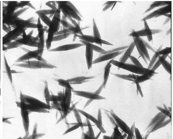
Fig.7-3 (b) 全体混合反応塔(循環無し) 酸化速度18.3%/h
