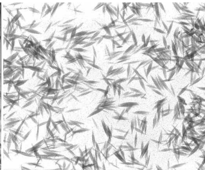
Fig.7-5 (b) 単純気泡塔(循環無し) 酸化速度28.5%/h
