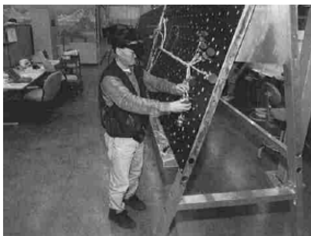
図 2.11: AR を用いた配線作業支援システム (ボーイング社) [13]
