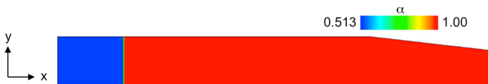
図 6.6 初期状態における発射薬の装填位置
