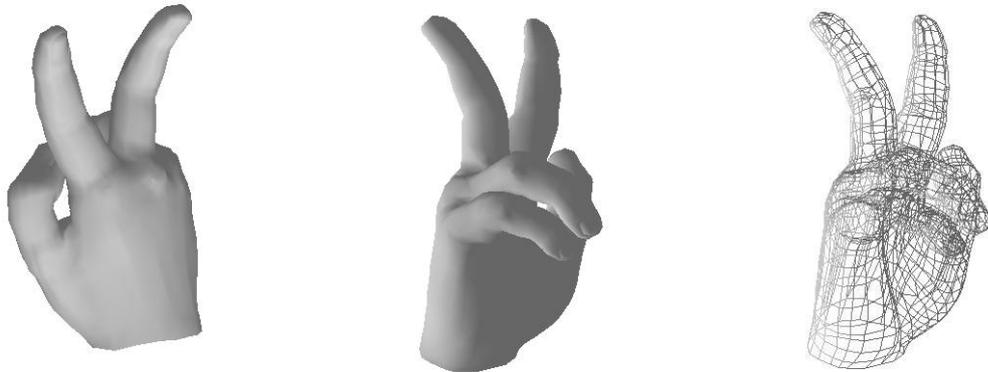
図 6.6: 一般的なポリゴンモデルの例
