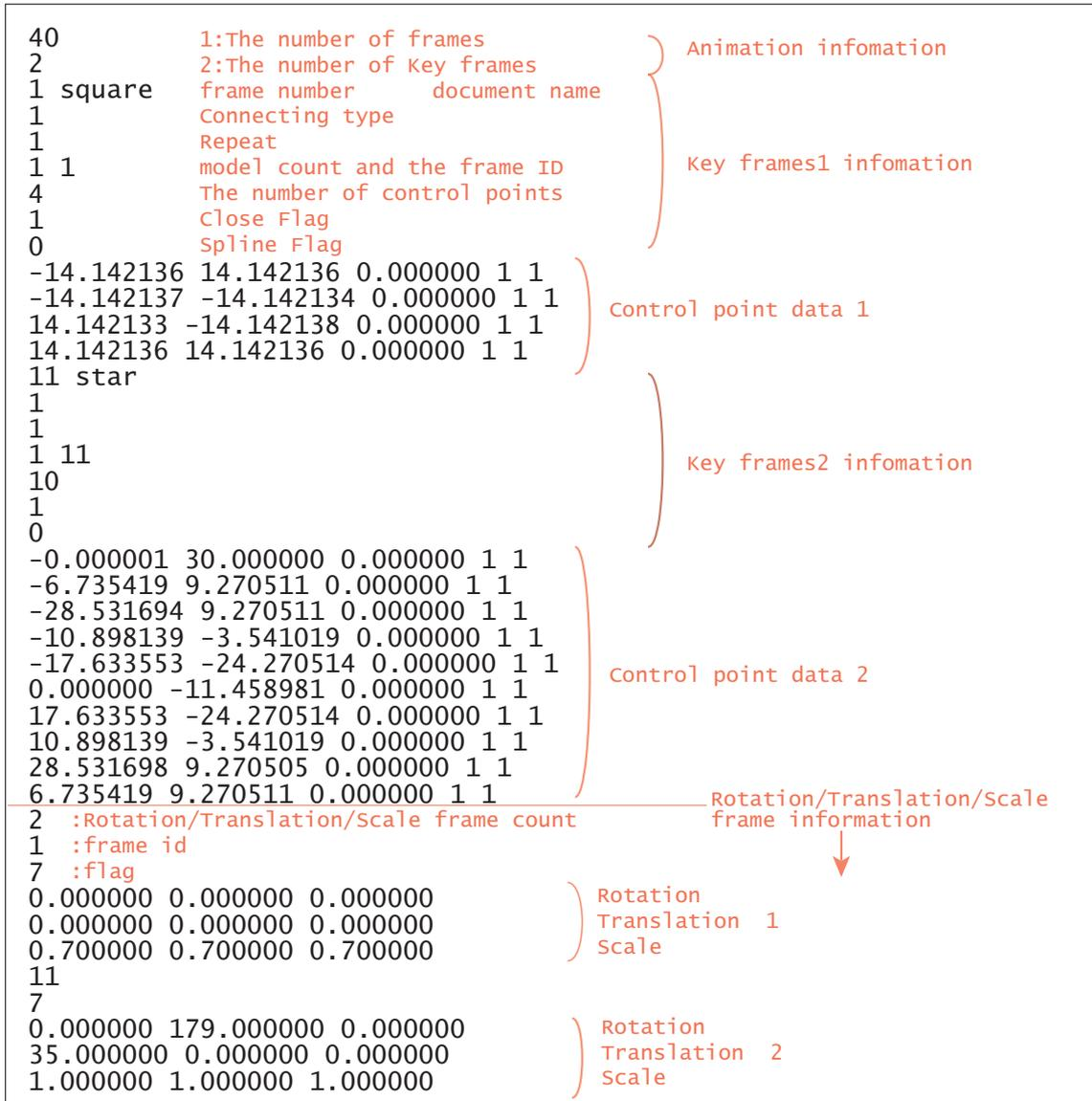
図 B.14: CAT の出力データの例 (アニメーション用, can ファイル)
