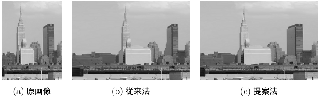
図 6.5 原画像 (a) の横幅を従来法 (b) と提案法 (c) を用いて 2 倍に拡大した結果 .
