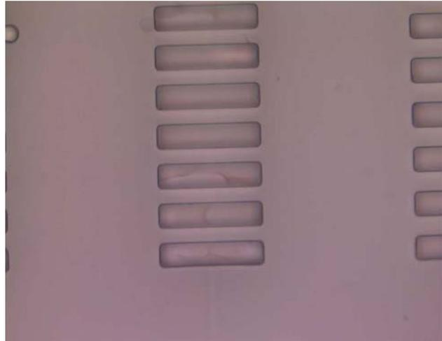
図 3.2-9 サイトップ™ 充填後の溝の拡大写真
