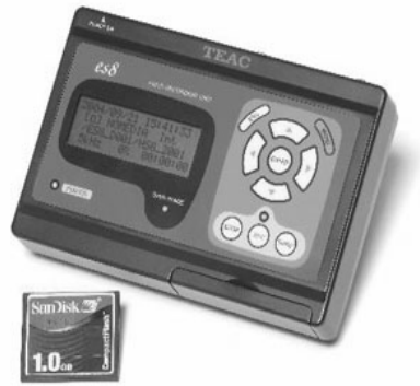
図 5.5 データロガ es 8 の外観．左下に写っているのは，使用したコンパクトフラッシュメモリ (TEAC HP, 2012) ．
