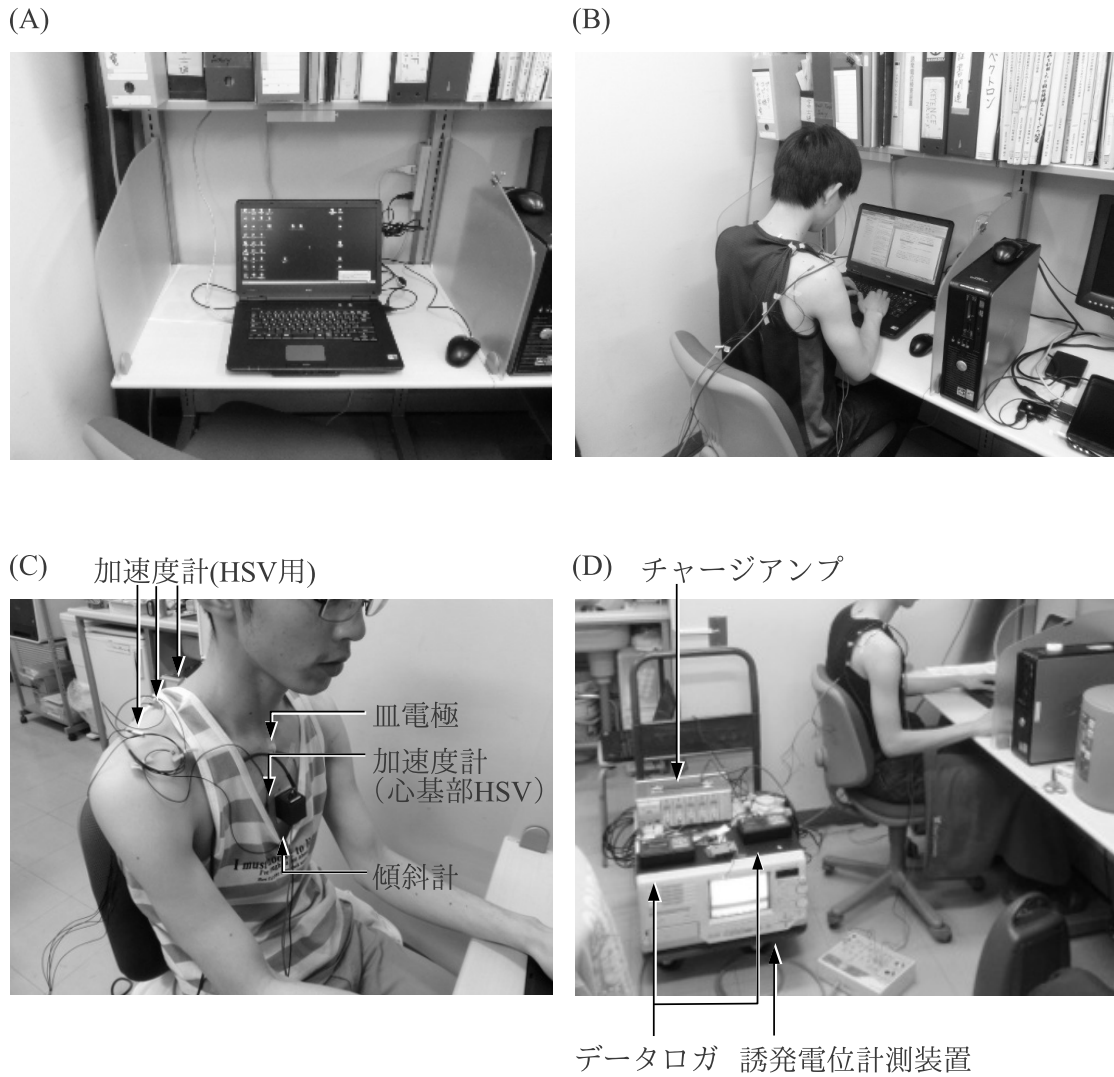
図 5.1 実験風景。(A) 実験時使用機とノートパソコン。(B) 計測風景。(C) 加速度計，傾斜計，皿電極の取り付け風景。(D) 計測システム全体。
